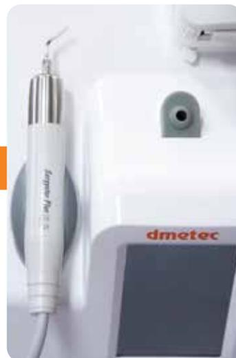
پس از اتصال هولدر هندپیس، مطابق تصویر، کانکتور هندپیس را متصل نمایید. لازم به ذکر است که بر روی کانکتور هندپیس و محل نصب آن بر روی پنل، با نقطه ای به رنگ قرمز علامت گذاری شده است که این دو نقطه باید در مقابل یکدیگر قرار گیرند.
